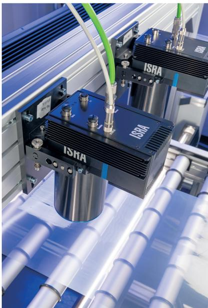
Bild 2. ISRA Vision Smash: Oberflächeninspektionssystem für Kunststoffbahnen © ISRA VISION AG
